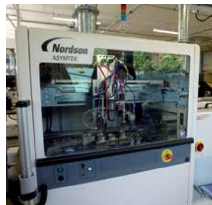
L'atelier de production des cartes électroniques est équipé d'une toute nouvelle machine de vernissage, ce qui permet de limiter les dépôts de poussière, la corrosion. Toutes les cartes de GYS seront désormais vernies, critère important pour les zones où existe un fort taux d'humidité.
