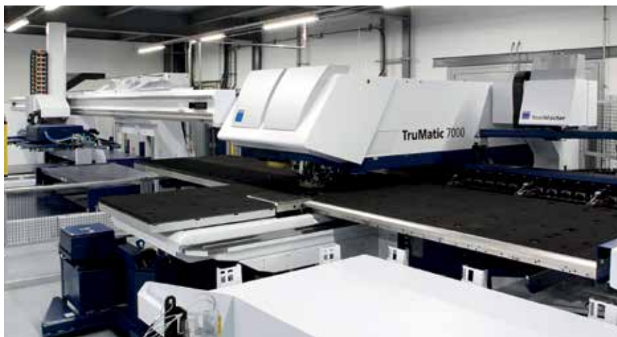
Parmi les investissements récents, ici dans l'atelier tôlerie, cette nouvelle machine à double tête est en mesure de faire à la fois des opérations de poinçonnage et de découpe laser. Cela permet de travailler des pièces d'une épaisseur plus importante, avec en prime un gain de temps et une qualité de coupe accrue.
