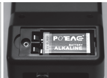
Vyměňte novou baterii 9V v přihrádce
