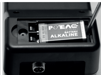
Vyměňte baterii vypáčením pomocí šroubováku
