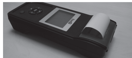
C. Vložte z přihrádky malou délku papíru a zavřete ji stisknutím průhledného krytu.
