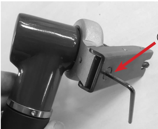
Utiliser la clé fournie pour régler la position de la plaque inférieure
