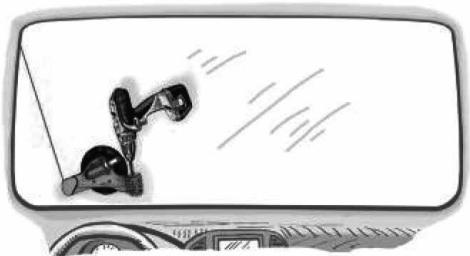
La separazione avviene in senso antiorario guardando dall'interno. Partendo dall'angolo in basso a destra, rimuovere circa 6–10 cm dallo spigolo inferiore del cristallo. (Fig. 3)
