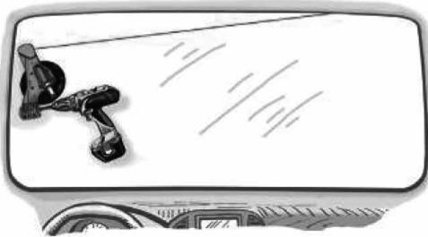
Azionare la pompa per vuoto (pompare circa 20–25 volte) finché l'anello rosso non è più visibile. Per rimuovere l'estrattore sollevare leggermente il bordo della ventosa in gomma e tenere fermo l'estrattore.
