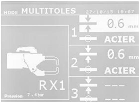
Este modo permite um ajuste preciso da espessura e tipo de cada uma das 2 ou 3 chapas
