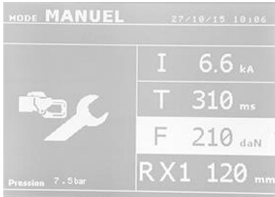
A tecla permite escolher a função ajuste do pinça A função «ajuste do alicate» permite fechar a alicate e aplicar o esforço de aperto programado nos eletrodos sem a passagem de corrente O alicate é fechado enquanto o operador puxa o gatilho. Esta função permite verificar a centralização das caps.
