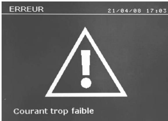
Se a corrente obtida durante um ponto for inferior ao valor do setpoint (6%), a máquina indica, uma vez efetuada o ponto uma mensagem de aviso de "corrente fraca" que o convida a verificar o ponto.
