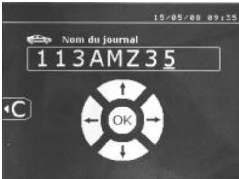
Запись отчёта позволяет сохранить данные по серии сварных точек, совершенных с помощью клещей, с тем, чтобы записать их на карту памяти (чип) и потом вывести их на компьютер. GYS предоставляет компьютерную программу, которая называется GYSPOT, позволяющую считывать информацию с SD карты и распечатывать отчёты на компьютере. Эта программа GYSPOT находится на SD карте вместе с инструкцией по эксплуатации. По умолчанию, эта функция выключается
