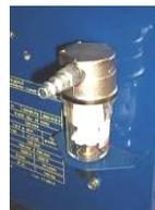
Пневматический фильтр, подключение к пневматической системе
