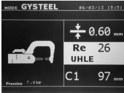
Режим Авто такой же как и Нормальный режим, за исключением того, что пользователь вводит предел упругости металла. Этот «Re» можно узнать с помощью такого инструмента (твердомера), как Gysteel Vision.
