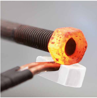
Ruostuneiden pulttien irrottaminen
