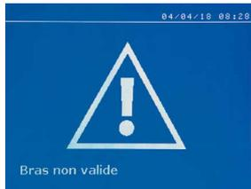
焊钳上的焊臂与所选焊接模式不匹配。
