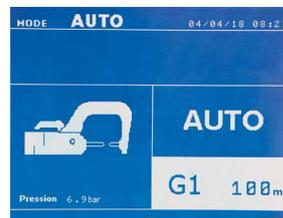
为了能够使用此模式，首先按照显示屏上的要求制作一个空焊 (电极间没有钢板)。按下按钮 (图2-11)。显示屏将显示“进行一次空焊”。再次按下按钮进行校准。一旦校准完毕，机器将所有参数显示为零，并可开始焊接。关闭待焊接区域的焊钳并自动焊接，无需在机器中输入参数。每30个焊点，机器将重新要求进行校准。
