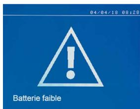
出现“电池电量低”信息，并提醒用户控制面板上的电池电压低。此电池确保设备关闭时保存日期与时间。
