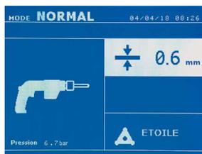
标准模式下，焊枪可焊接最厚为1.5mm的钢板。
