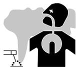
焊接产生的烟雾，气体和灰尘对人体有害。预先准备好足够风力的风扇，保持空气流通。若通风不足，可使用新鲜空气面罩。
