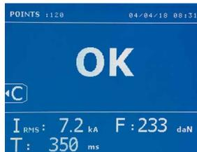
焊点计数器可用相同的电极帽计算所执行的点焊量。若焊点无问题，会显示以下信息。
