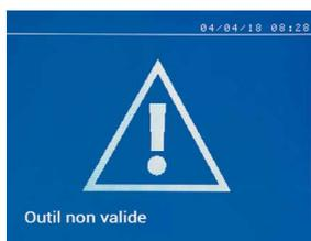
出现“工具无效”信息，并提醒用户一个按钮/一个扳机仍处于启动状态，或者机器检测到永久性短路。请控制焊枪扳机和按钮，消除此消息。
