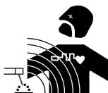
电流能通过任何导体产生局部的电场和磁场（EMF）。焊接电流在焊接电路和焊接设备周围产生电磁场。
