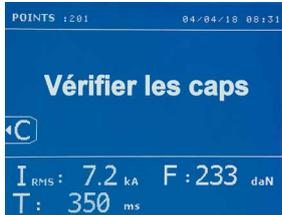
若用相同的电极帽所执行的点焊量超过200个，显示屏则会在之后的每次执行点焊时，显示一条警告信息，直到用户将焊点计数器清零。机器独立计算每个焊臂的焊点数。
