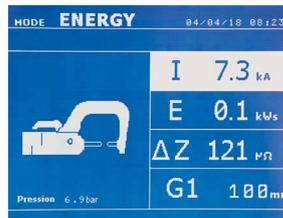
为了使用此模式，首先须制作一个空焊。按下按钮（图2 -11）。显示屏将显示“进行一次空焊”。再次按下按钮进行校准。校准完成后，机器会在显示屏上显示此模式中用于电流和能量的最后一些数值。。用户则可以更改焊接电流，能量及阻抗。机器焊接足够的时间以达到所需能量。若焊接时间过长，机器会显示一条“已达最长时间”的错误信息。
