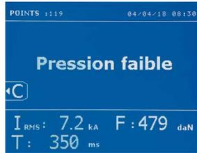
若输入压不足以确保所需的夹紧力，机器将发出蜂鸣声并在进行点焊之前显示错误信息“电源压力不足”。
