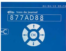
储存报告可将用焊钳所执行的点焊数据存于储存卡中，以便之后（例如，在电脑上）读取。借助GYS开发的GYSPOT软件，可在电脑上读取SD卡并编辑报告。此软件储于SD卡中及安装说明内。
