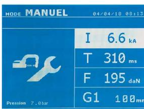
操作键 可选择焊钳设置功能。“焊钳设置”功能可关闭焊钳并在不通过电流的情况下将编程的夹紧力施加到电极。操作者按住扳机时，焊钳保持关闭状态。此功能可检查接头是否居中。
