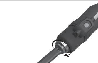
Maks. tilspændingsmoment = 7 Nm
