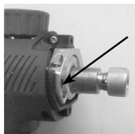
Ajustar o comprimento das varetas da pistola para obter uma dimensão L = 120mm (dimensão entre a extremidade das varetas e o bordo dos flanges)
