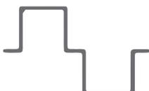
**MSW (Modified Sine Wave)** : Die MSW-Modelle erzeugen eine modifizierte Wechselwelle. Sie eignen sich zum Aufladen der meisten Haushaltsgeräte und elektronischen Geräte wie Telefone, Kameras, Laptops, Beleuchtung ...
