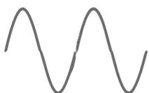
**PSW (Pure Sine Wave)** : PSW-Modelle liefern eine stabile Spannung, die die gleiche Qualität wie ein Stromnetz hat. Sie können alle Geräte versorgen, auch die empfindlichsten (Leuchtstoffröhren, Fernseher, stationäre Computer usw.).
